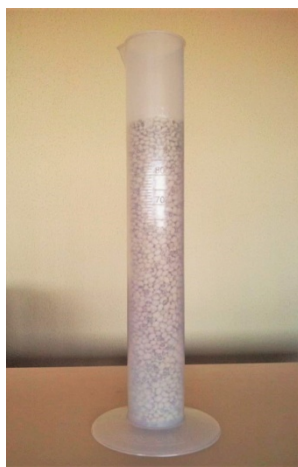
FIGURA 2. Ilustração da determinação da contração da massa das sementes de feijão-caupi ao longo da secagem em uma proveta graduada de 1000 \text{ mL} .
