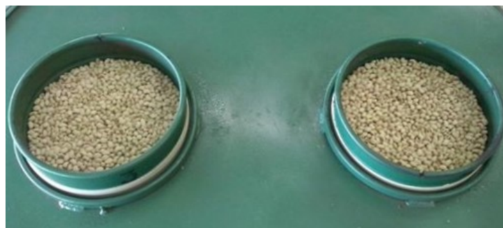
FIGURA 2. Camada delgada de sementes de feijão-caupi disposta nas bandejas do secador.
